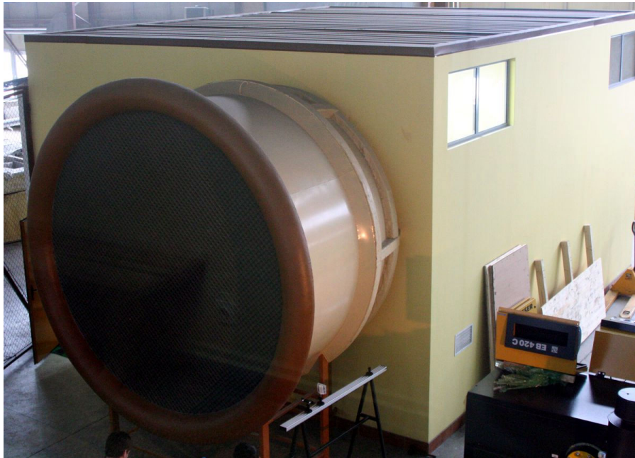
Tunel do badania śmigieł lotniczych
