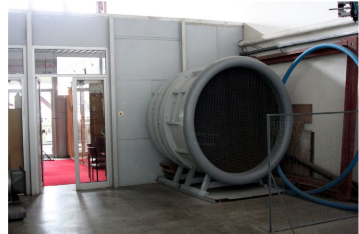
Tunel aerodynamiczny w układzie przelotowym
